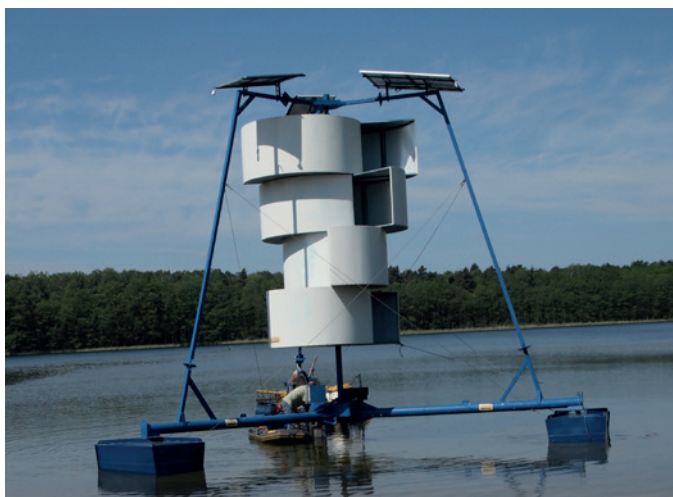
Aerator pulweryzacyjny, natleniający wodę naddenną z wykorzystaniem siły wiatru i słońca
